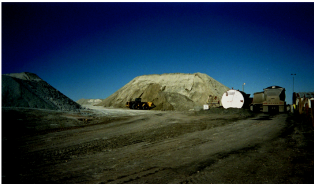
Figur 5. Karbonatisering av bentonit i upplag. Materialet tas från nedre delen av raskanten och tillförs den sluttande delen på andra sidan. Fotot är taget av Rolf Sjöblom och är från American Colloid Company's anläggning för utvinning av bentonit i Wyoming, USA.
